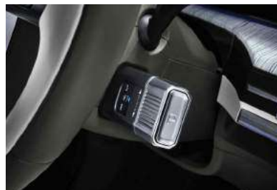
Руль бағанындағы беріліс селекторының интірегі (SBW)
