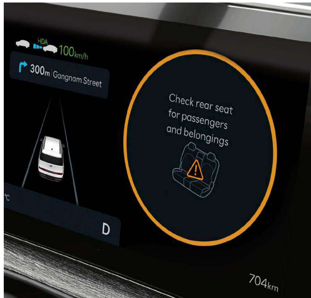
Артқы орындықта жолаушының болуы туралы хабарлайтын жетілдірілген жүйе (ROA)
